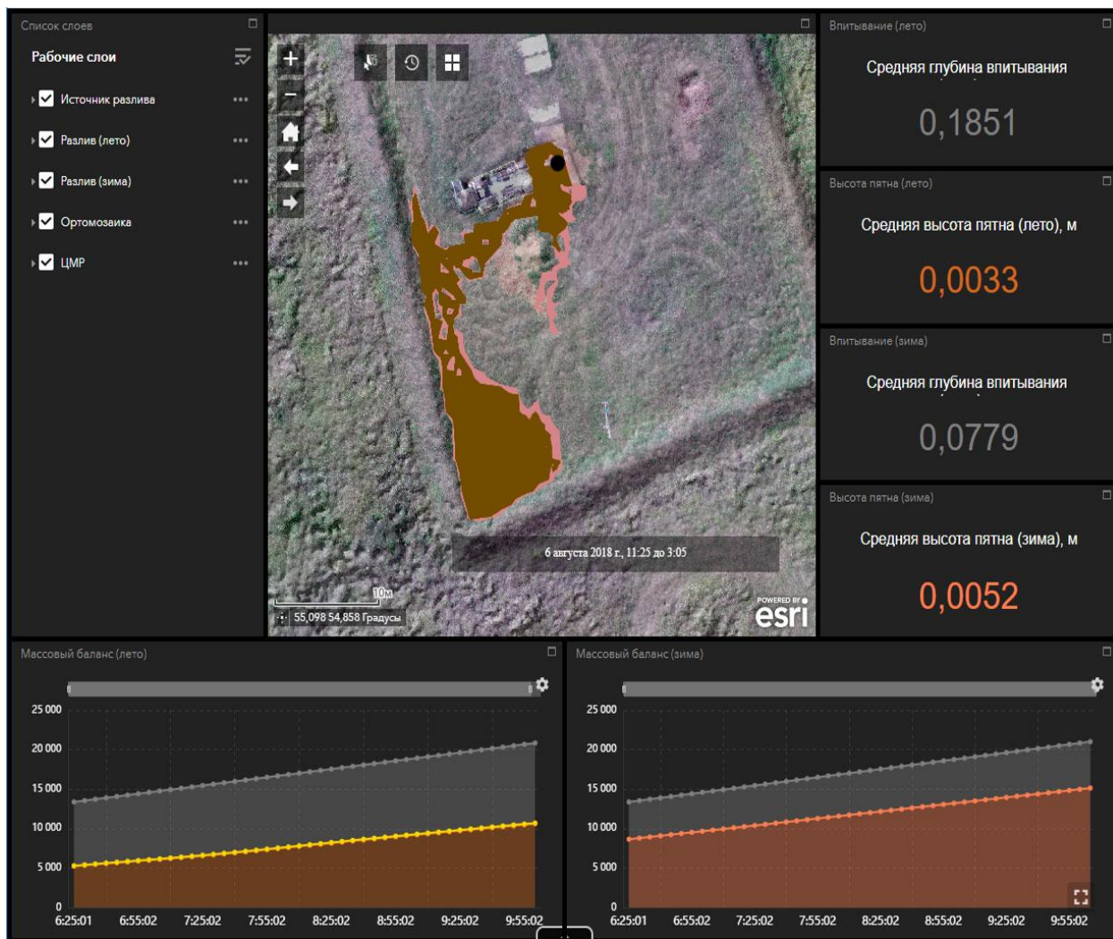
Рис. 5. Пример использования подробной цифровой модели рельефа для моделирования разлива нефти.
